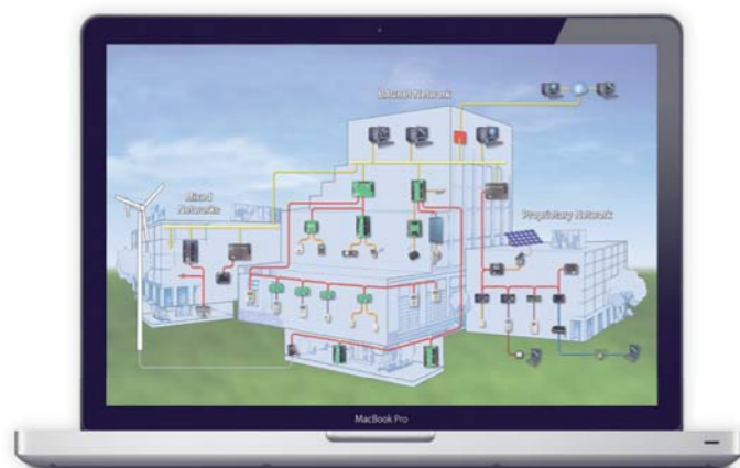
BMS - Система управления зданием
