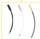
TC, TZ, Pt100 Zewnątrzny czujnik temperatury o długości 3m, 6m, 12m - TC/TZ: termistor NTC 12 kΩ/ 25 °C - Pt: czujnik Pt100 (tylko TER-3G). str. 147
