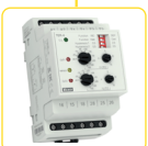
TER-4 Szeroki i dokładny zakres ustawienia -40.. +110 °C w 10-ciu zakresach w jednym urządzeniu, precyzyjne ustawienie temperatury, 2 wejścia dla czujników NTC, 2 wyjścia CO 16A, funkcje (pamięć, histereza, sygnalizacja uszkodzonego czujnika temp.). Zasilanie: 230 V AC lub 24 V AC/DC (galwanicznie odseparowane). str. 136
