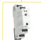
TER-7 Kontrola zagrzewania uzwojeń silnika w zakresie oporowym wbudowanego PTC termistora (1.8-3.3 kΩ), funkcje (pamięć, reset), styk wyjściowy 2x 8A CO, zasilanie: 24-240 V AC/DC. str. 135
