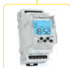
TER-9 2 wejścia temperatury, 2 wyjścia 8A przełączne, 6 funkcji, zegar sterujący, podświetlony LCD, galwanicznie odseparowane zasil. 230V AC, 2 moduły. Zakres temperatur -40.. +110 °C. str. 138
