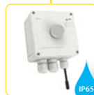
TEV-3 Termostat pro regulaci vytápění (chlazení), nastavitelný rozsah +5 .. +35 °C, externí senzor NTC, výstupní kontakt 16 A, ovládací potenciometr a indikace na panelu. str. 144
